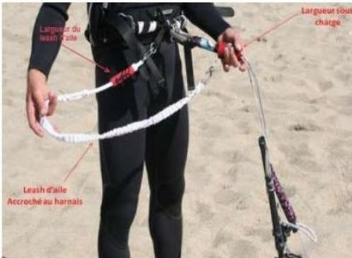
Le largueur sous charge ou déclencheur: permet de se désolidariser de la barre et de l'aile en cas de problème. Celle-ci perd de sa puissance et tombe.
